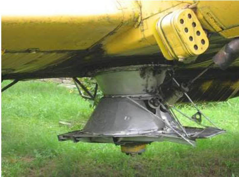
Unter der Tragfläche die Auslassvorrichtungen für Dünger und Schädlingsbekämpfungsmittel
