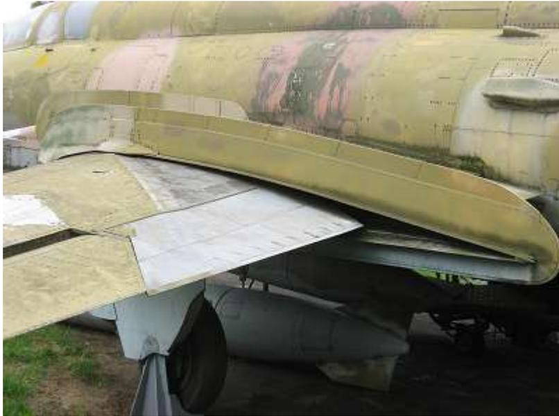
Hier erkennt man deutlich den Spalt, in den die Tragfläche einschwenkt
