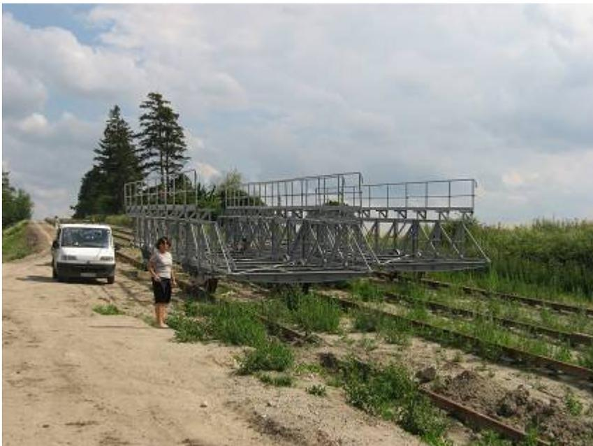
Die Gestelle, auf die die Schiffe zum Transport aufgesetzt werden
